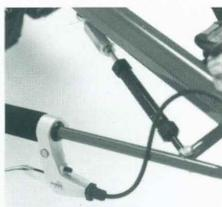
*Potro de prueba de silla Maratón. Detalle del estabilizador de dirección hidráulica. Diseño a medida para cada usuario con apoyo en tres ruedas.*
