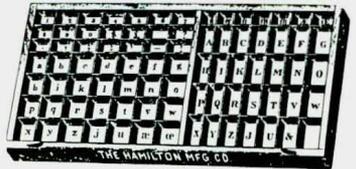
4. Poliza tipográfica de la fundidora AMERICAN TYPE Foundry Co, Buffalo, 1906. En ella se muestran cajas conteniendo tipos de metal.
